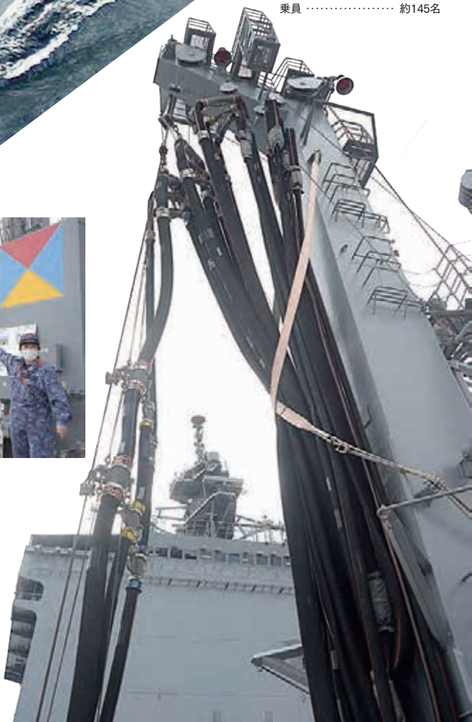
黒いホースのような物は、燃料・航空燃料・真水などの補給時に使用する蛇管、先ほど立ち寄った艦橋とウイングがあんなに高くに。
