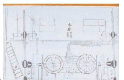
水磨様の写し(福岡市麺類商工協同組合蔵)。水車、歯車、石臼が連動して粉をひくという水車製粉の仕組みが記されています。
