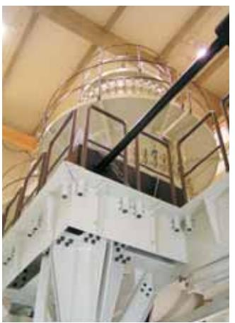
部を表しているそうです。材料工学部 中島邦彦教授にご案内頂き、C E二号館の超高压電子顕微鏡室に入りました。教室内には見慣れた顕微鏡とは大違いの、これが顕微鏡かと思わせる高さ八メートルの大きな器械です。金子賢治準教授の説明を聴きながら、ナノ・ピコの世界に触れました。顕微鏡は二十数億円、高価な世界一の顕微鏡に驚きました。
